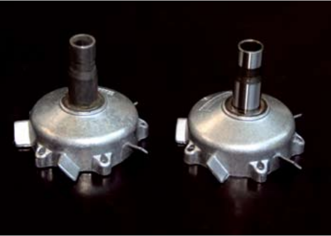
Abb. 3: Elektromotorenwelle: Werkstück links ungeschliffen, rechts geschliffen
