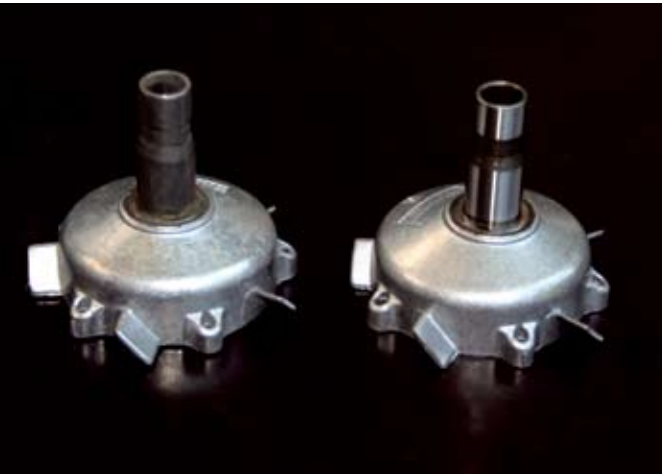
Abb. 3: Elektromotorenwelle: Werkstück links ungeschliffen, rechts geschliffen
