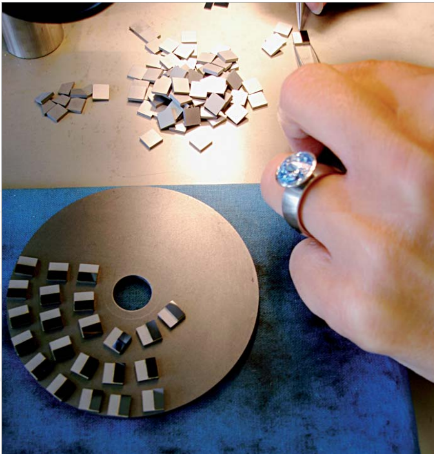
Montage von CVD-Diamant auf Hartmetall
